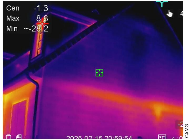
Sur cette image thermique, on peut voir que le mur latéral est bien isolé. Seul le plancher des combles constitue un «pont thermique» par lequel la chaleur s'échappe.
